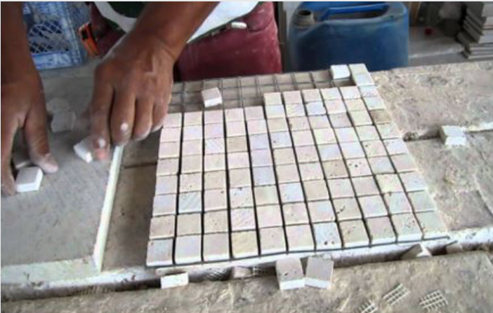
Figura 3. Tapete de recubrimiento con pequeños cortes cuadrados de mármol. Tomada de [5]
