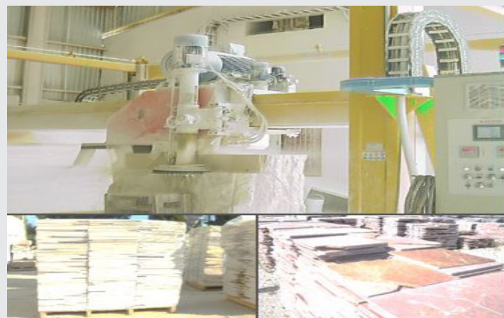
Figura 1. Máquina de parquet y las mermas del proceso productivo del mármol. Tomada de [3]
